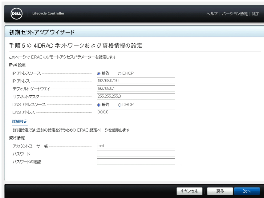
図 6. iDRAC Network and Credential Configuration (iDRAC ネットワークと資格情報の設定) ページ
